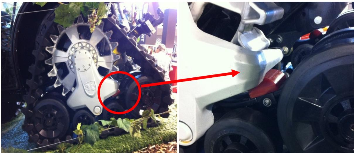
**Abb. 100:** Konstruktive Veränderungen am Bandlaufwerk des Carraro Mach 4. Der eingefügte Hartgummipuffer begrenzt den Pendelweg des Laufwerks und begrenzt somit die einseitig-ungleichmäßige Druckverteilung in der Kontaktfläche.
