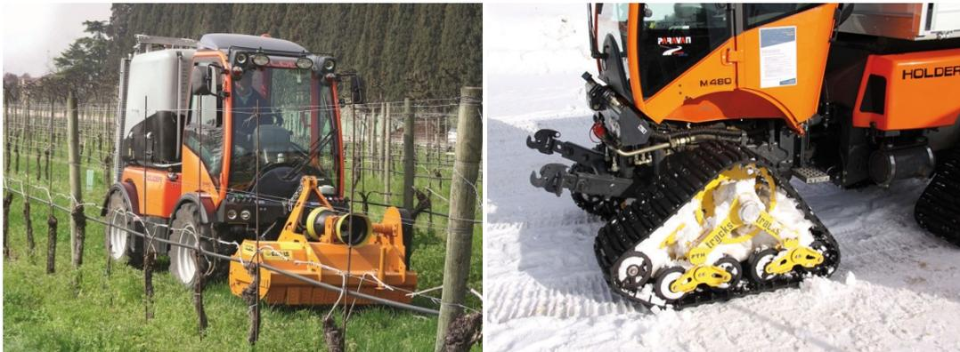
**Abb. 7:** Holder Systemtraktor M 480 mit Standard- und Bandlaufwerk (HOLDER 2014).
