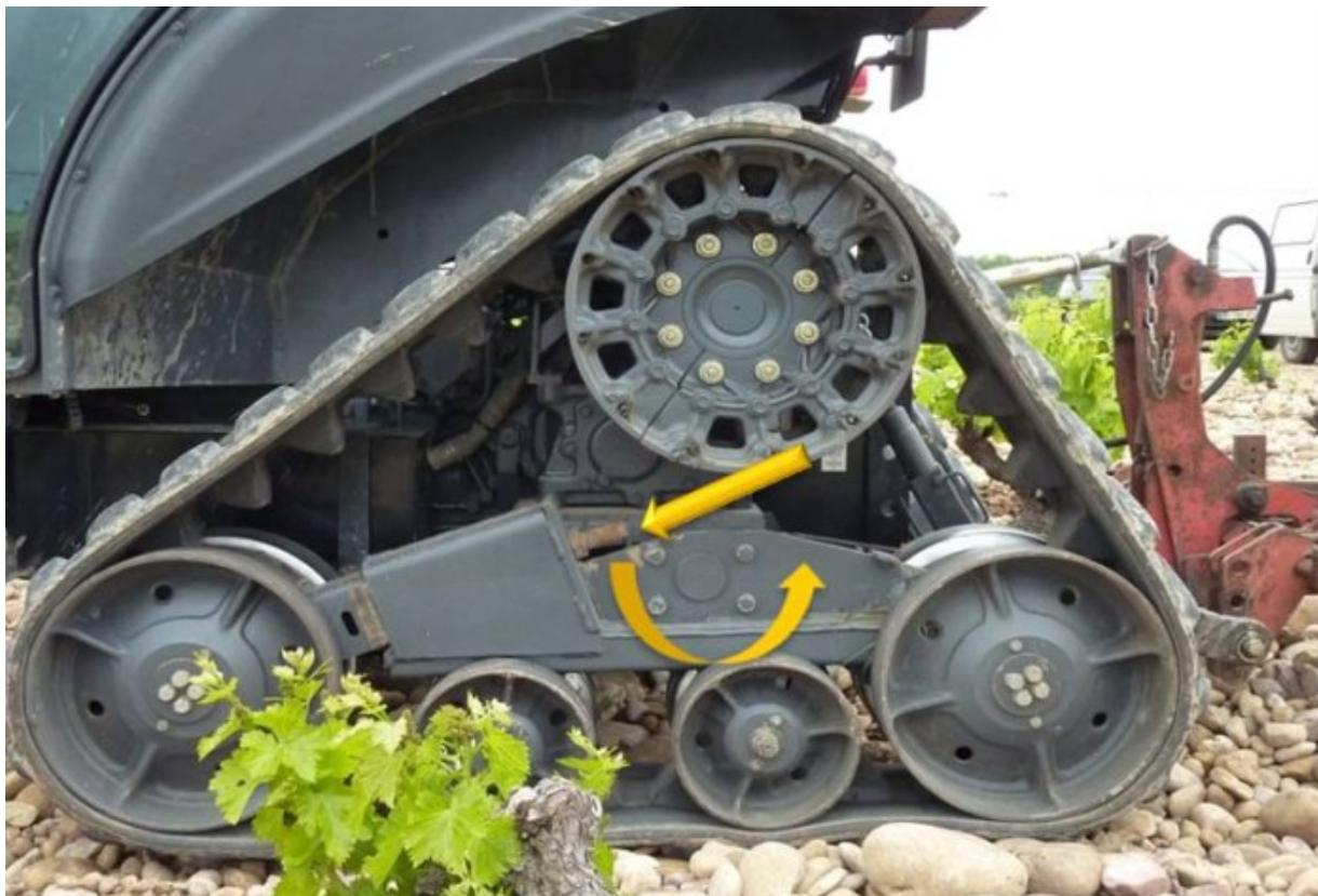
**Abb. 10:** Detailaufnahme des Anbaulaufwerks beim M 8540 Narrow mit Kennzeichnung (gelbe Pfeile) der Spannvorrichtung und des Fahrwerkdrehpunkts (KUBOTA 2014).
