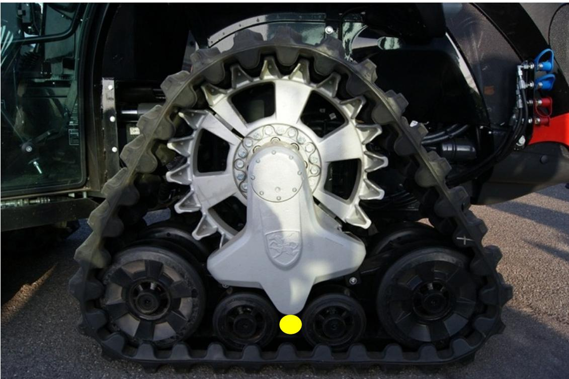
**Abb. 36:** Detailaufnahme eines Bandlaufwerks des Versuchsfahrzeugs Carraro Mach 4. Der Drehpunkt der Lagerungsschwinge ist mit einem gelben Punkt gekennzeichnet.
