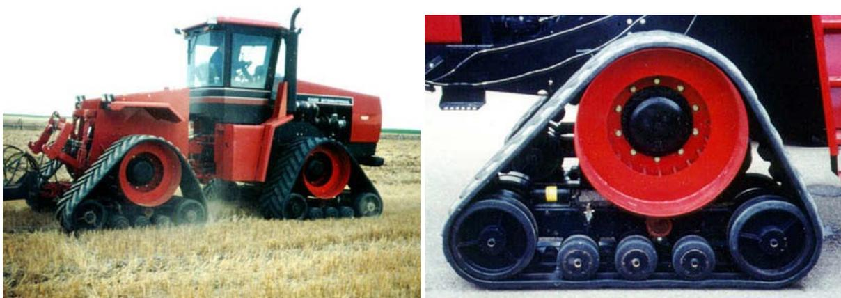
**Abb. 96:** Prototyp des Case-IH Vierraupentraktors aus der Experimentalstudie von TURNER (1995).
