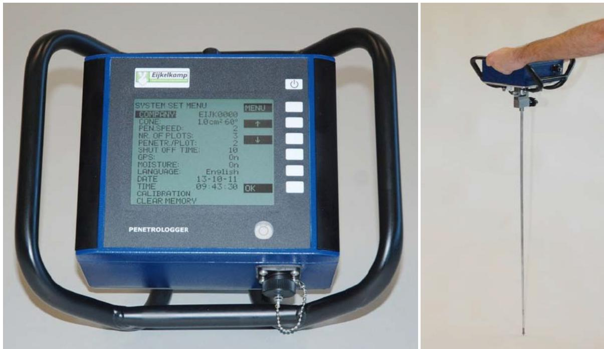
**Abb. 45:** Vertikal-Konus-Penetrometer, Typ: Eijkelkamp Penetrologger (EIJKELKAMP 2011).
