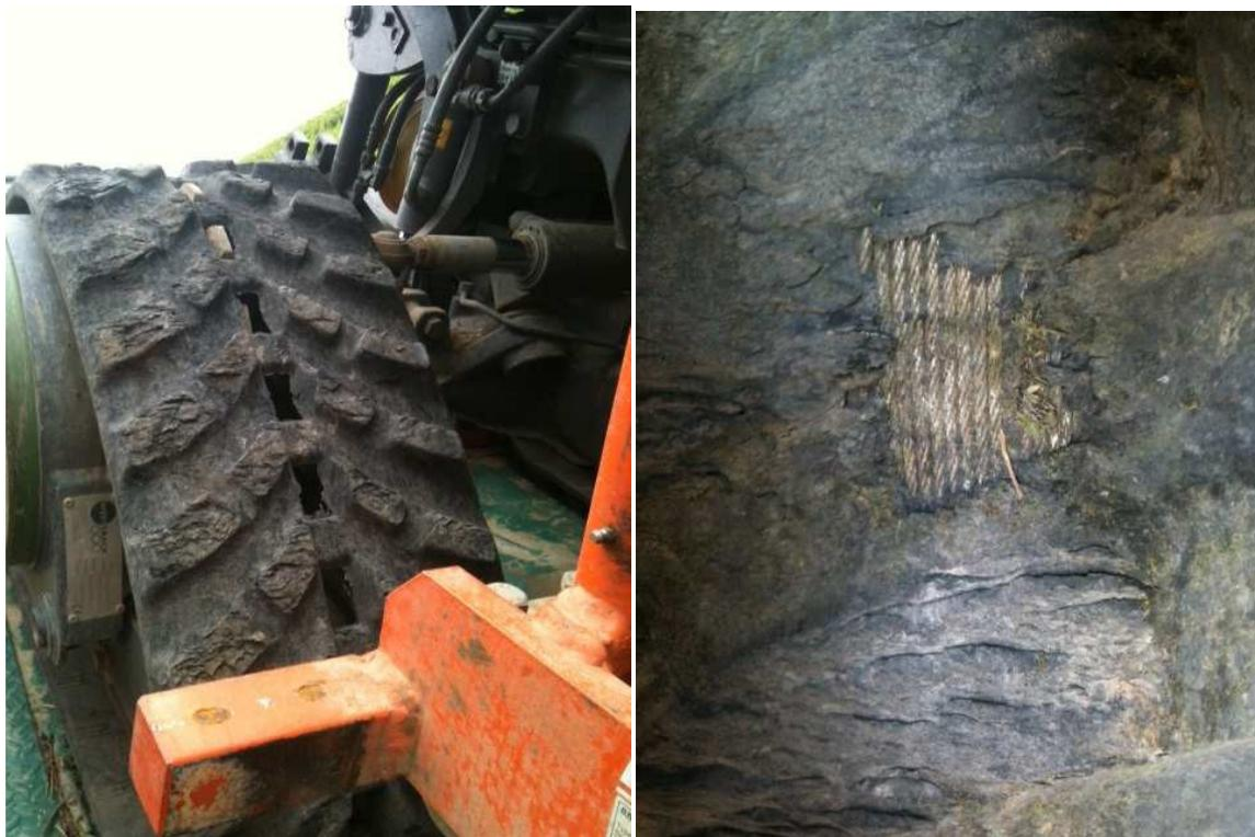
**Abb. 101:** Schäden am Gummigurtband nach rd. zweijährigem Einsatz in skelettreichen Weinbausteillagen (BALDAUF 2012).
