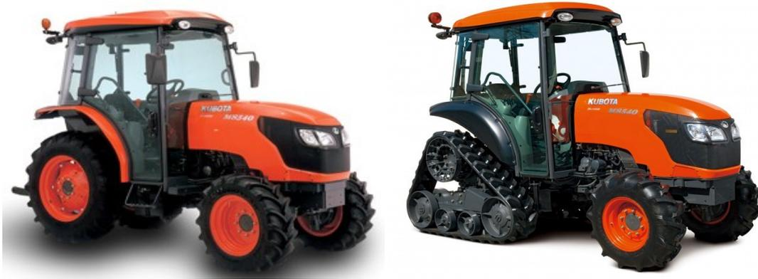
**Abb. 9:** Schmalspurtraktor M 8540 Narrow mit Standard- und Halbraupenfahrwerk (KUBOTA 2014).
