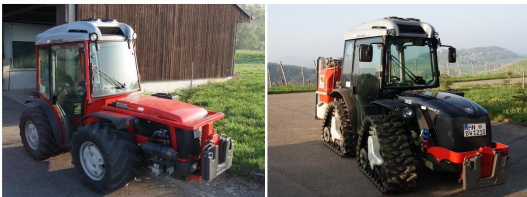
**Abb. 8:** Schmalspurtraktor Carraro SRX mit Knicklenkung und Mach 4 mit Bandlaufwerken.
