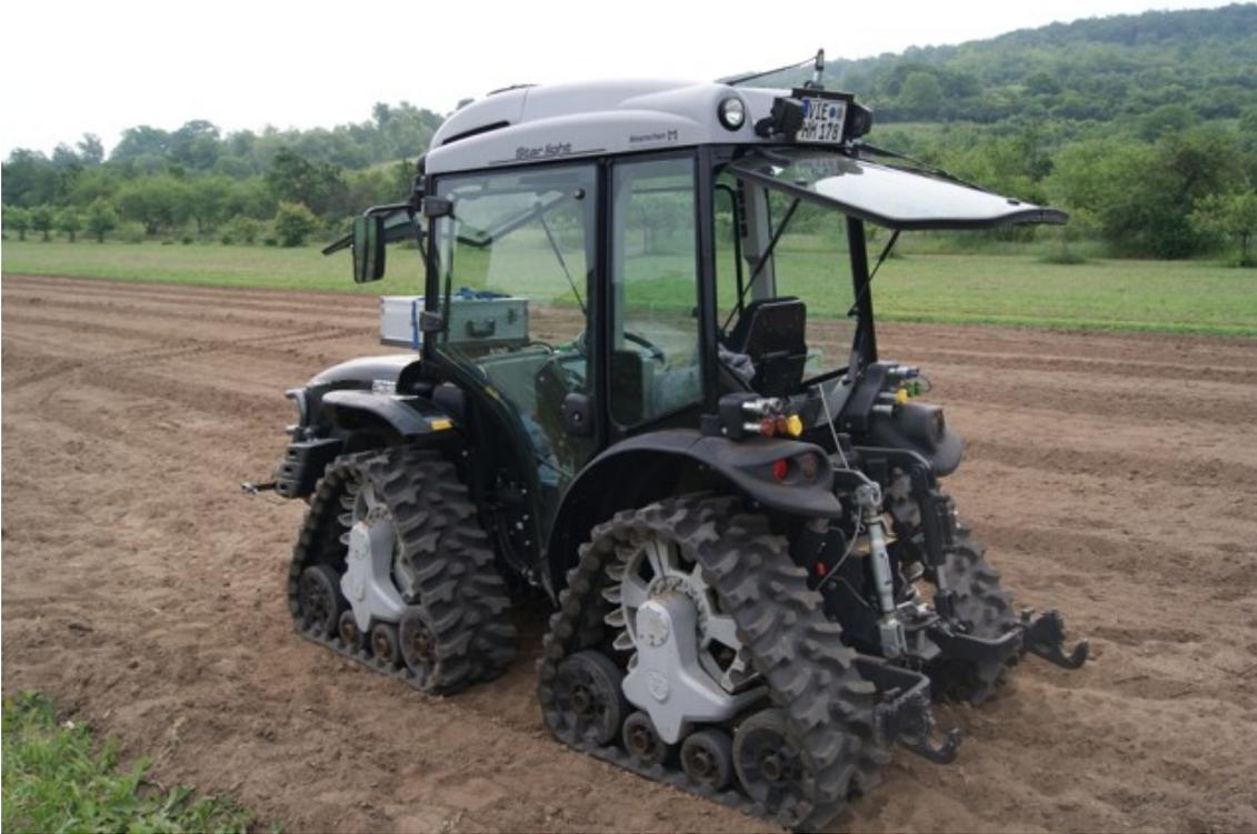
**Abb. 35:** Versuchsfahrzeug Mach 4 (Weinbauschmalspurschlepper, Knickschlepper, Bandantrieb), Hersteller Carraro, Bandgröße 0,35 m x 1,14 m.
