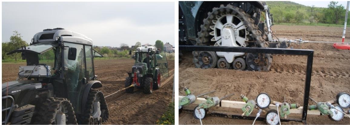
**Abb. 44:** Versuchsaufbau zur Variation der Verzögerungskraft während der dynamischen Bodendruckmessungen. Der kraftschlüssig an das Versuchsfahrzeug gekoppelte Bremsschlepper erlaubte eine definierte Abbremsung während der Messüberfahrt.
