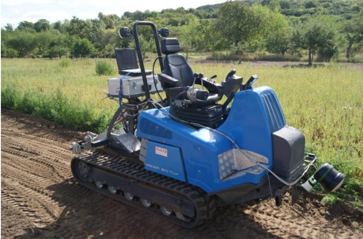
**Abb. 37:** Versuchsfahrzeug Geier 60 TLY (Schmalspurraupentraktor leichter Bauart; hydrostatischer zweisträngiger Raupenantrieb), Hersteller Geier, Bandgröße 0,25 m x 1,20 m.
