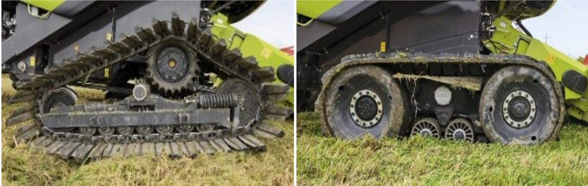
**Abb. 16:** Bandlaufwerke mit formschlüssigem (links) und kraftschlüssigem (rechts) Antrieb (CLAAS 2014).
