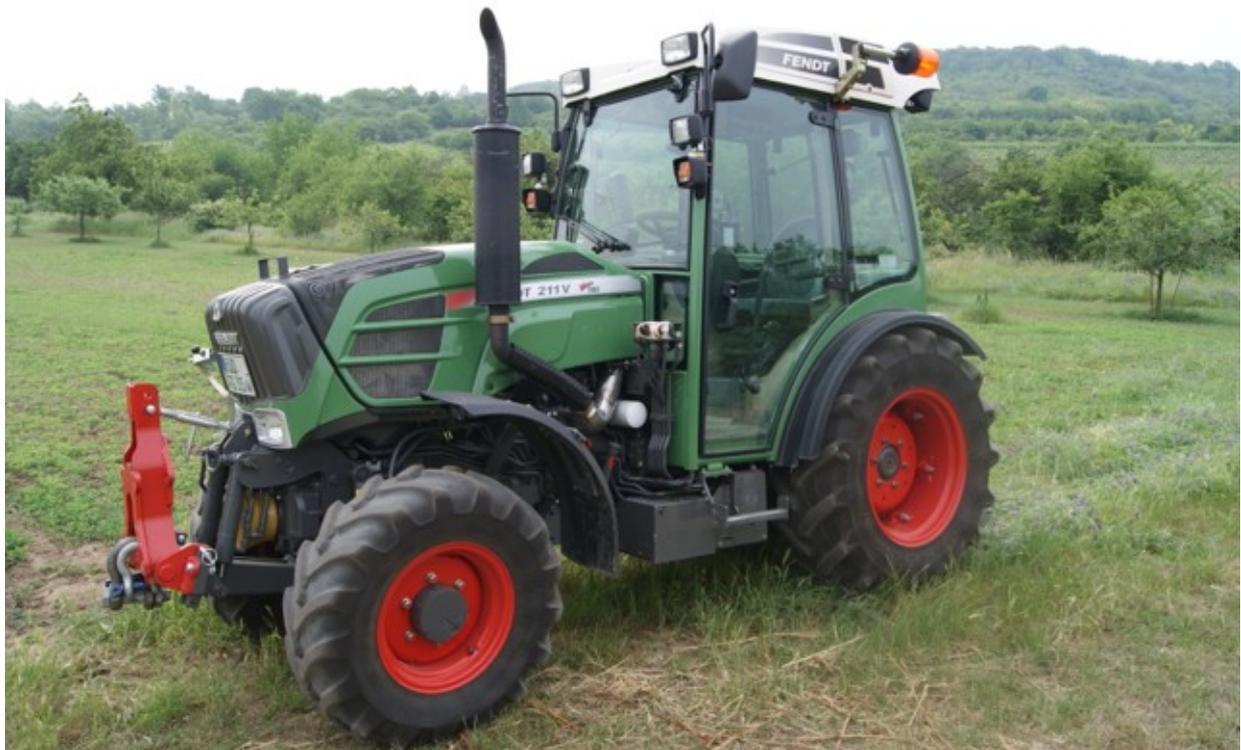
**Abb. 34:** Versuchsfahrzeug 211V Vario TMS (Weinbauschmalspurschlepper, Standardbauweise, unechter Allradantrieb), Hersteller Fendt, Bereifung Vorderachse (VA) Michelin 11 LR 16, Hinterachse (HA) Michelin 380/70 R 24, Stollenprofil XM 27.
