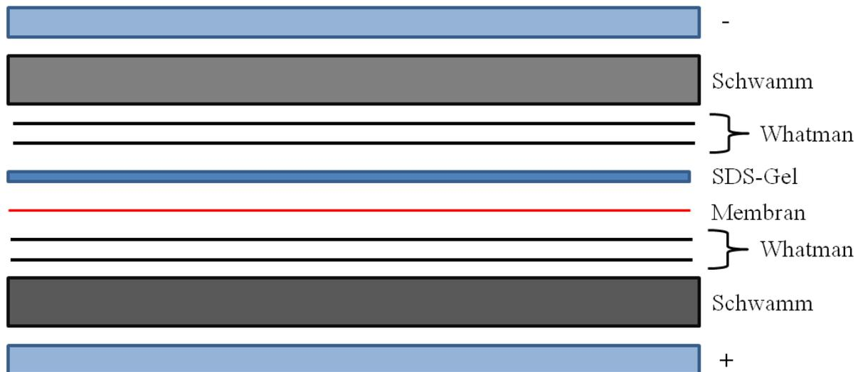
**Abbildung 10: Schematische Darstellung des Aufbaus der Western-Blot-Apparatur.** + Stellt die Anode da, - stellt die Kathode da (hell-blau), Schwämme (grau), Whatman-Papier (schwarze Linie), SDS-Gel (dunkel-blau), Membran (rot).
