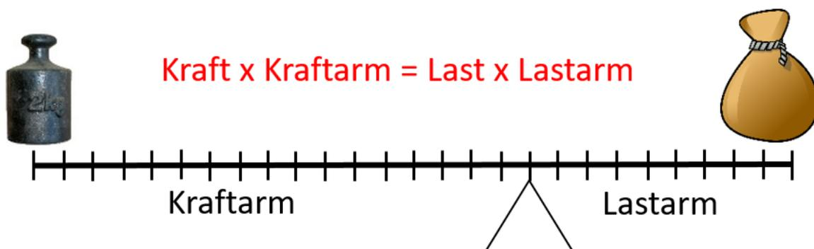
Abb. 8: Das Hebelgesetz von Archimedes
