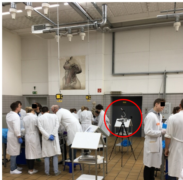
Abbildung 11: Raumluft-Probenahme mittels BiVOC2-Sammler
