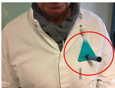
Abbildung 10: passive Personenmessung mittels Radiello®-Passivsammler
