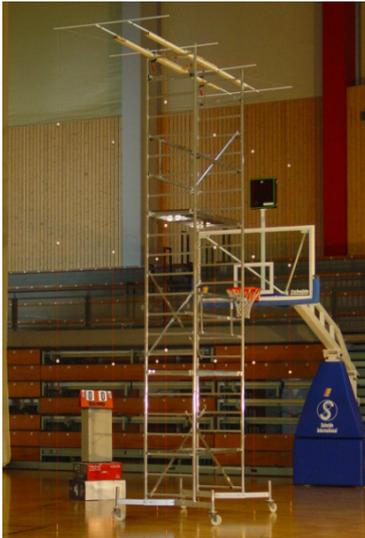
Abbildung 29: Kalibrierungssystem mit 24 Messpunkten zur Erfassung des Ballfluges beim Freiwurf.
