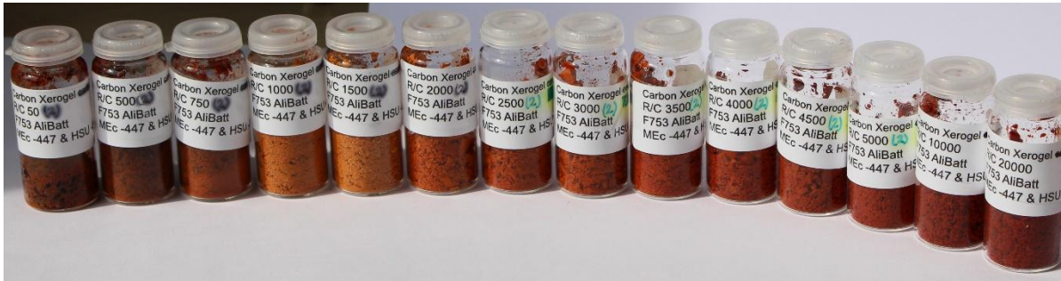
Abbildung 3-5 Synthetisierte Resorcinol-Formaldehyd-Xerogele mit unterschiedlichen R/C -Verhältnissen
