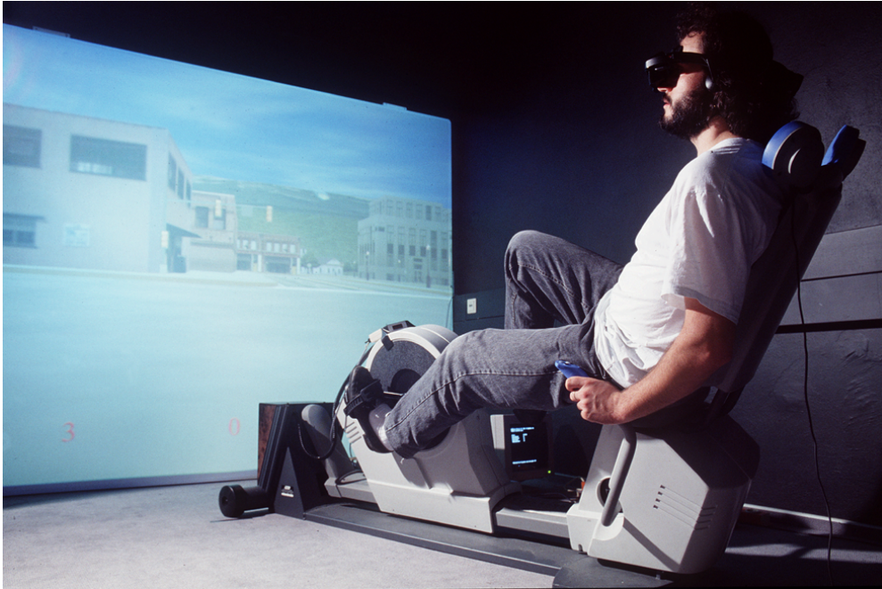
Abb. 55 zeigt die wesentlichen Interaktionselemente (VR-Fahrrad, Projektionsschirm) der ersten Generation der Simulationsanlage.
