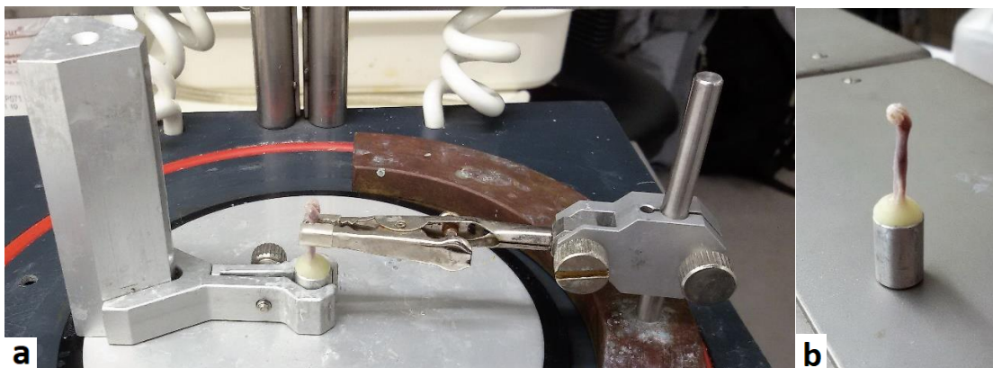
Abb. 2.2: Aluminiumhülse mit linkem Femur und Zahnzementkleber in der Klemmhalterung (a) sowie zur Messung vorbereiteter Femur (b)
