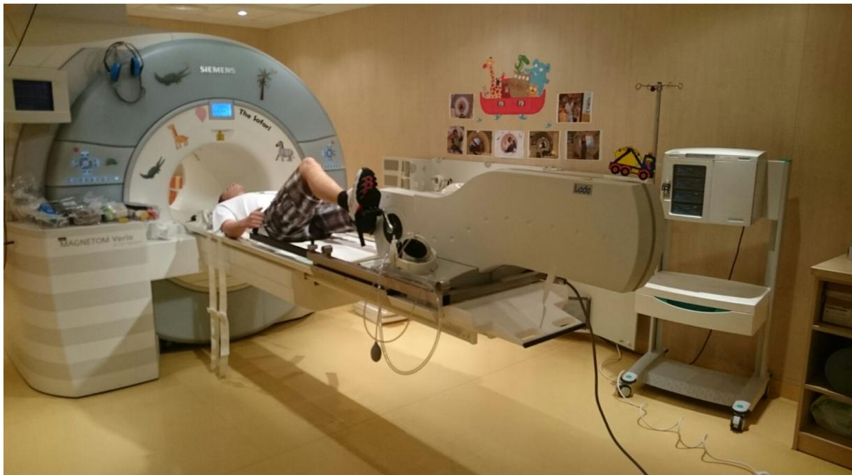
**Abbildung 4:** Aufbau des Fahrradergometers am MRT. Patient befindet sich noch nicht in der Scanner-Bohrung. (Eigene Darstellung)
