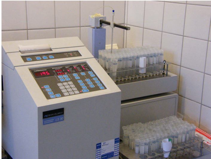
Abb. 52: Lumineszenz-Spektrometer Typ LS 30.
