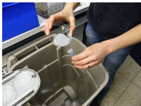
Abb. 51: Probenaufbereitung der Farbstofflösungen für die Messung mit dem Photometer.
