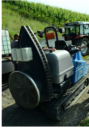
Abb. 21: Lochmann G24 Sprühgebläse.
