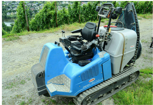
Abb. 18: Raupen-Mechanisierungssystem (RMS) Geier 60 TLY.
