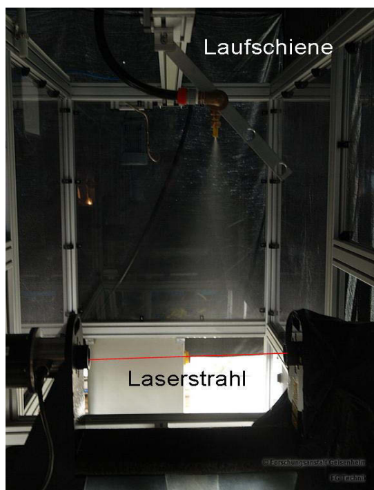
Abb. 31: Messstand zur Tropfengrößenbestimmung.
