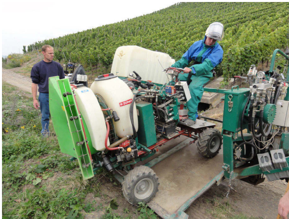
Abb. 17: Steilhang-Mechanisierungssystem (SMS) Firma Obrecht.
