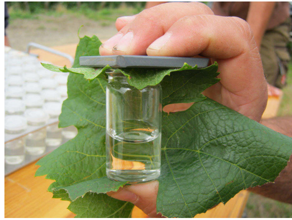
Abb. 37: Überführen des Tracerstoffes von der Blattoberfläche ins flüssige Medium.
