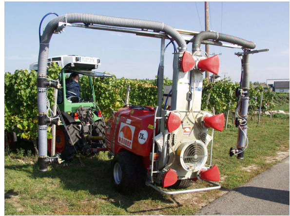
Abb. 24: Wanner GR 56 Sprühgebläse.
