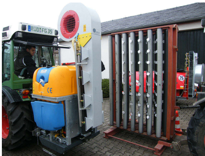
Abb. 44: Durchführung der Penetrationsmessung.
