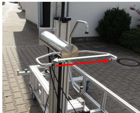
Abb. 30: Eine Messsequenz des Ultraschallsensors „Ultrasonic Anemometer 2D“.
