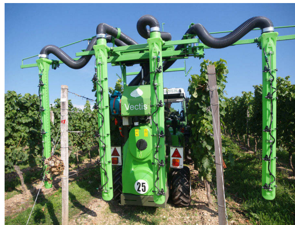
Abb. 26: Tecnomat Vectis Sprühgebläse.
