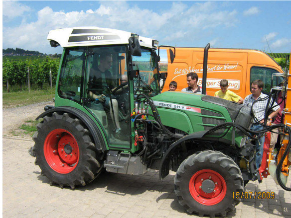
Abb. 15: Schmalspurschlepper Fendt 211 V Vario TMS.
