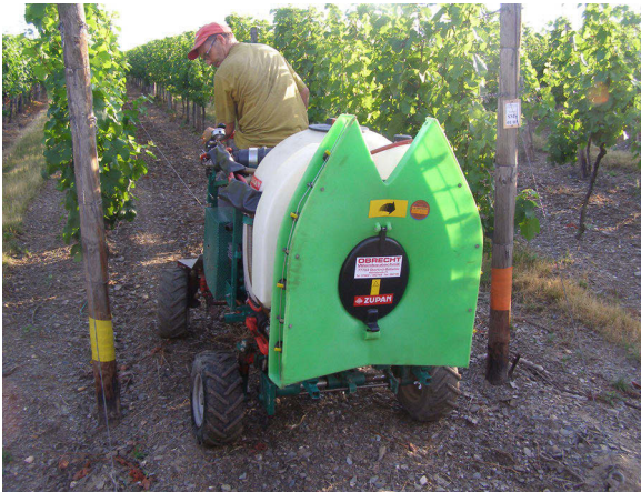
Abb. 23: SMS "Zupan" Sprühgebläse.
