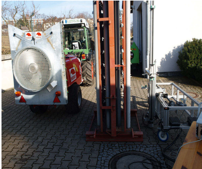
Abb. 45: Luftmessung nach Messstandpenetration bei dem Sprühgerät ZA 28.
