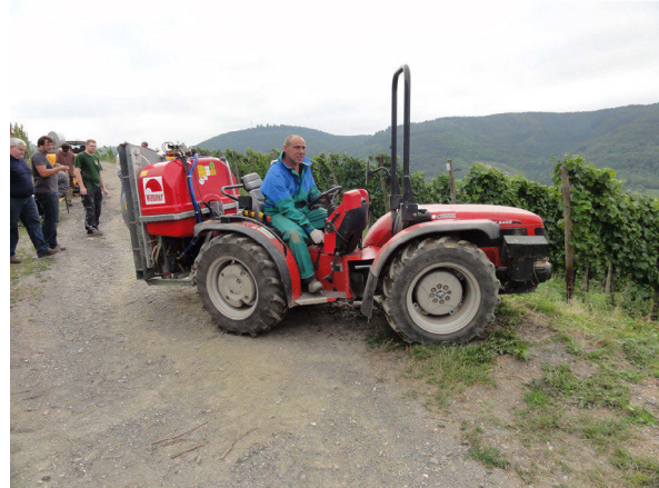
Abb. 16: Knicklenkerschlepper Carraro SRX 8400.
