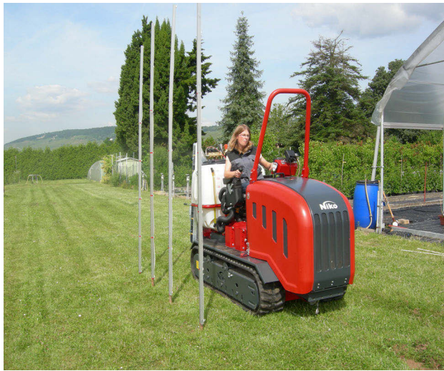
Abb. 34: Aufbau der Freilandversuche zur Vertikalverteilung während der Fahrt.
