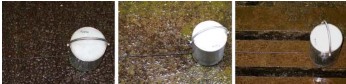
Abb. 26: Verschiedene Bodenbeläge, präpariert für die Gleitreibungsmessungen
