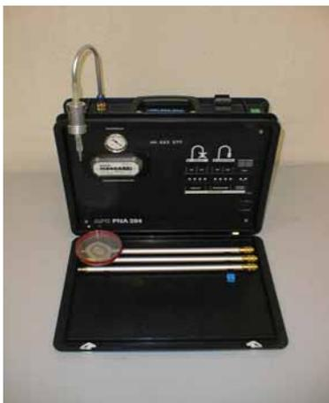
Abb. 3.6: Probenahmepumpe
