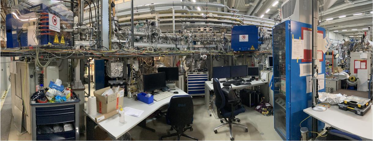
**Abbildung 3.11** – Panoramafoto des Arbeitsplatzes an PIPE. Links im Bild ist der Analysiermagnet, in der Mitte oben ist die Wechselwirkungszone, direkt rechts davon der Demerger-Magnet und die Detektorkammer.
