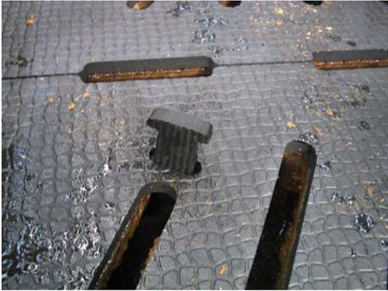
Abbildung 22: Produkt E Oberfläche mit Fixierungselement
