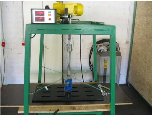
**Abbildung 8: Dauertrittbelastungsprüfstand der DLG**
