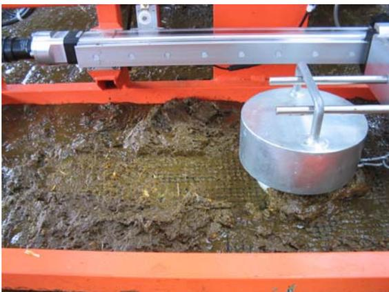
**Abbildung 27: Messung Rutschfestigkeit bei starker Verschmutzung**
