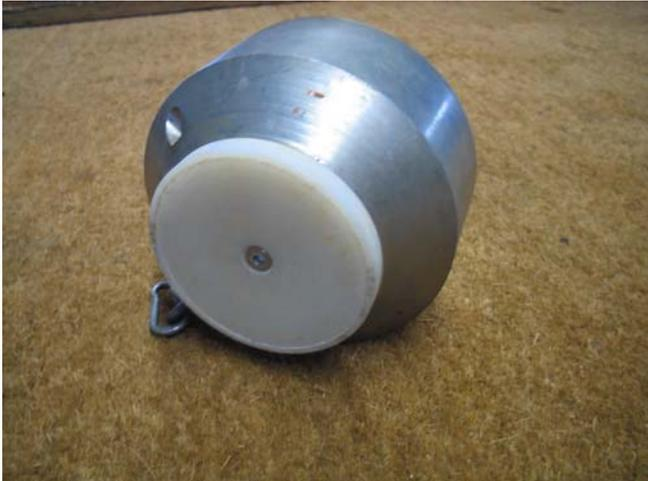
**Abbildung 11: DLG Prüfgewicht mit Prüfkörper aus Polyamid**
