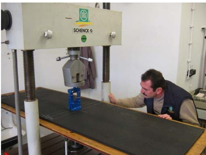
**Abbildung 7: Messung der Elastizität/Verformbarkeit mit der Hydropuls-Werkstoff-Prüfmaschine der DLG**
