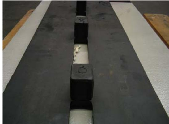
Abbildung 25: Produkt F Unterseite mit Befestigungsnoppen
