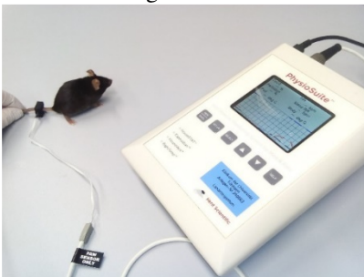
Abb. 18: Ruhepulsmessung an der Schwanzvene mit dem PhysioSuite -Gerät von Kent-Scientific.
