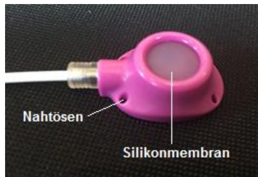
Abbildung 2: Konnektion zwischen Katheter und Kammer
