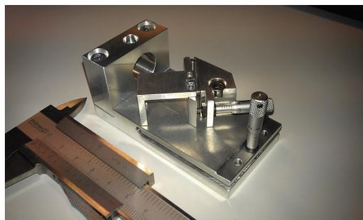
(b) Laserjustiervorrichtung, ohne eingesetzte Diode und ohne Einhausung.
