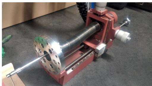
Abbildung 3.15.: Fotografie des mechanischen XYZ-Manipulators vor dem Einbau. Dieser kann die Diagnosekomponenten zur Strahlstrom- (Abbildung 3.16a), Strahlprofil- (Abbildung 3.16b) und Energieverteilungsmessung in den Elektronenstrahl fahren.
