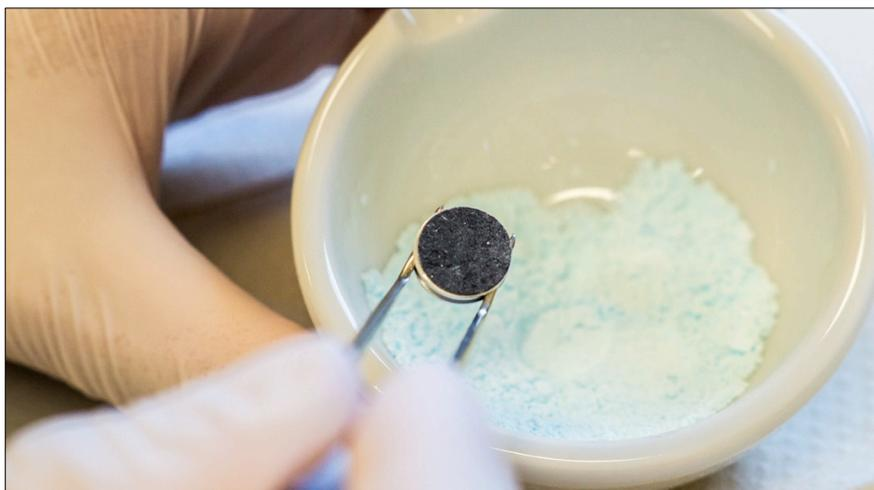
**Abb. 2.06:** Gleichmäßige Bedeckung der Probesteller.
