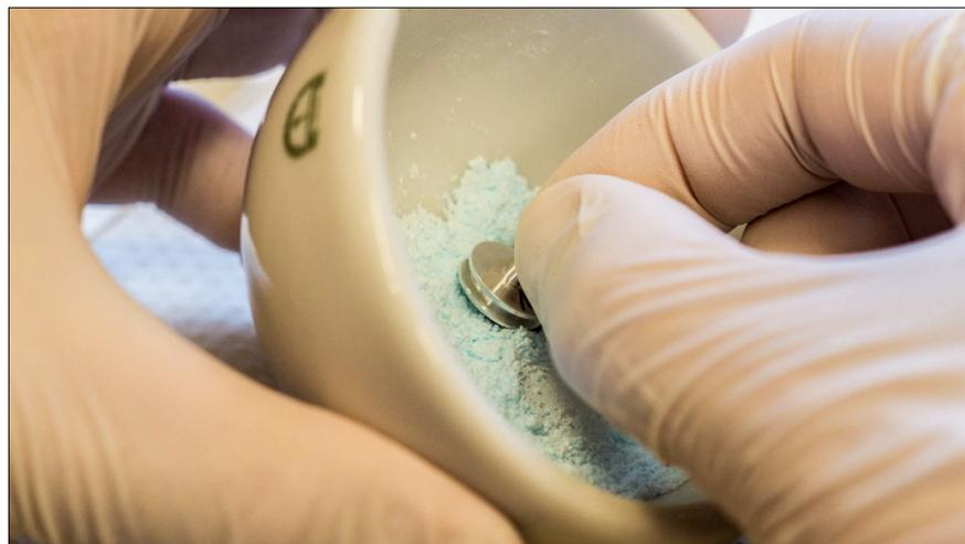
**Abb. 2.05:** Druckloses Auftragen des zerkleinerten Sediments.
