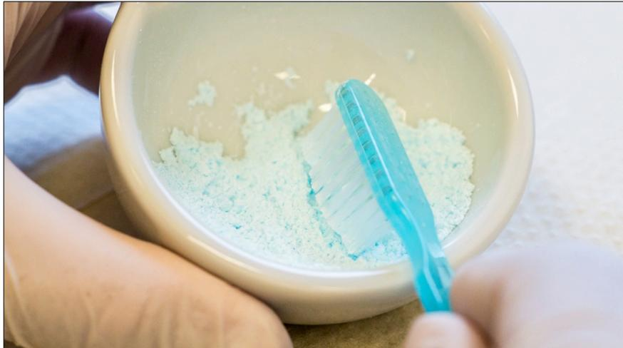
**Abb. 2.04:** Zerkleinerung des getrockneten Sediments bzw. des Überstandes der Zahnpastenslurries.
