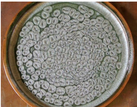
Abb. 99: Bénard-Konvektion (hier in Kupferschale erhitztes Silikonöl mit Silberbronze)
