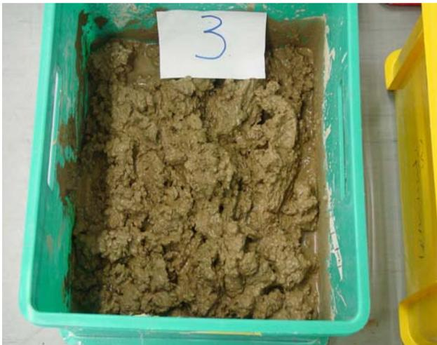
Abb. 4: Bodenproben mit 300 g  $\text{Ca}(\text{OH})_2$  und 1800 g Wasser, eingemischt in 8 kg Boden (Versuch C)
