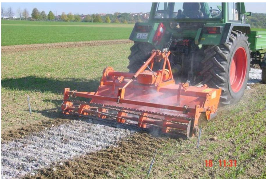
**Abb. 19:** Fräsen der Versuchsflächen bis ca. 15 cm Bodentiefe zur Realkalisierung des Bodens nach Ende der Versuche
