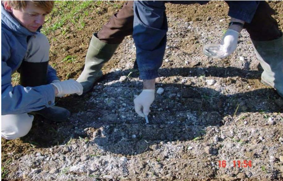
**Abb. 18:** Einbringung der mit den Prüforganismen kontaminierten Keimträger in ca. 5 cm Bodentiefe der jeweils gekalkten Versuchsflächen
