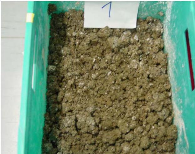
Abb. 2: Bodenproben mit 300 g  $\text{Ca}(\text{OH})_2$  und 600 g Wasser, eingemischt in 8 kg Boden (Versuch A)
