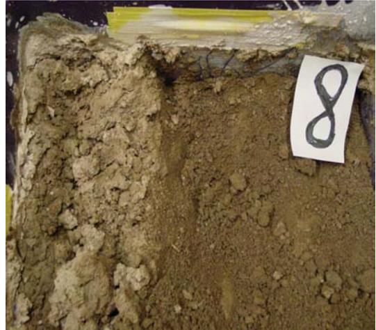
Abb. 10: Boden behandelt mit Kalkmilch,  $\text{Ca}(\text{OH})_2$  mit der abgetragenen oberen Erdschicht
