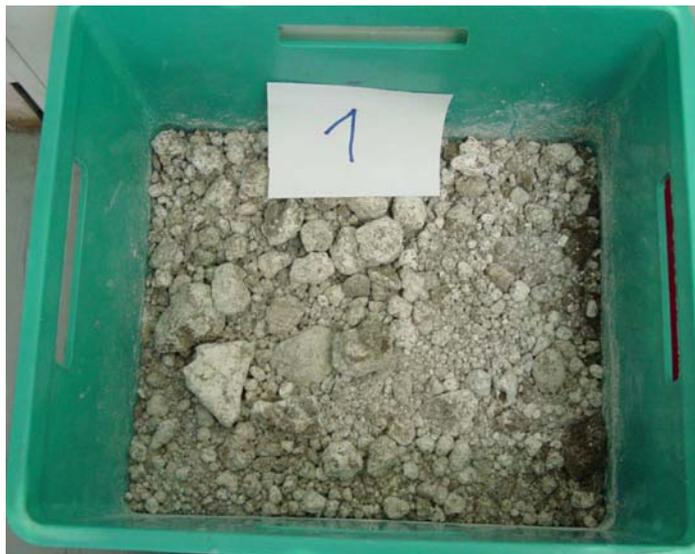
Abb. 1: Plastikcontainer mit 8 kg Boden, 300 g CaO gemahlen und eingemischt
