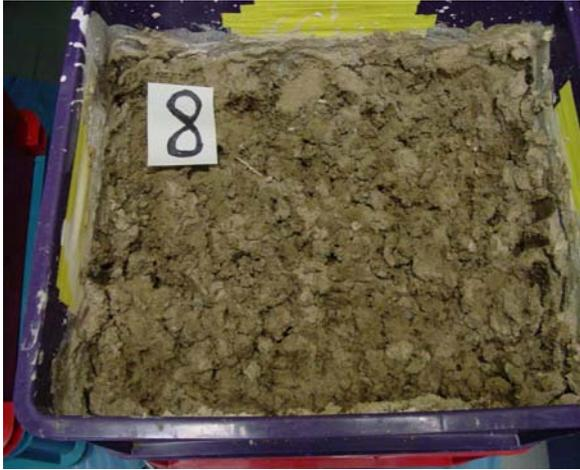
Abb. 9: Boden behandelt mit Kalkmilch,  $\text{Ca}(\text{OH})_2$  ohne abgetragene obere Erdschicht
