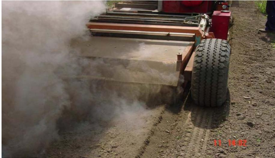
**Abb. 15:** Thermokammer, in der die Bodenpartikel mit Hilfe der Umkehrfräsen geschleudert werden und somit hohen Temperaturwerten ausgesetzt sind
