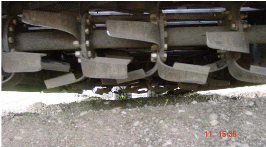
**Abb. 14:** Umkehrbodenfräse mit Rotation gegen die Arbeitsrichtung zur besseren Zerkleinerung der Bodenpartikel bei variabler Tiefeneinstellung
