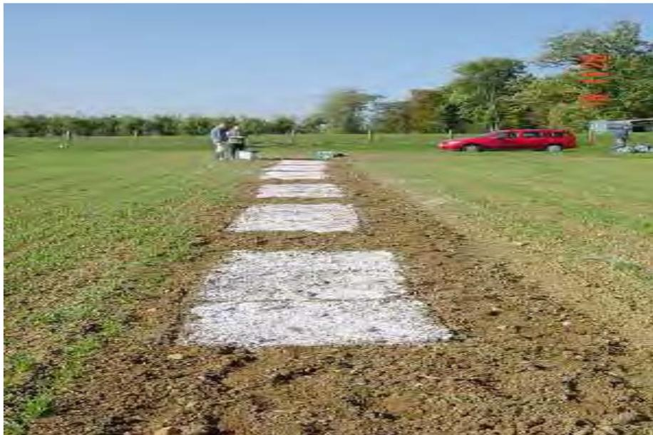
**Abb. 17:** 6 Versuchsflächen mit Kalk; im Vordergrund 0,8 kg CaO/m<sup>2</sup>, im Hintergrund 1,6 kg CaO/m<sup>2</sup>
