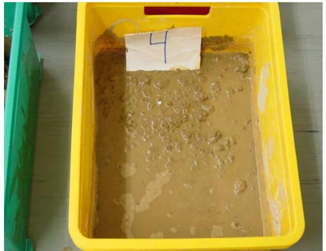
Abb. 5: Bodenproben mit 300 g  $\text{Ca}(\text{OH})_2$  und 2400 g Wasser, eingemischt in 8 kg Boden (Versuch D)
