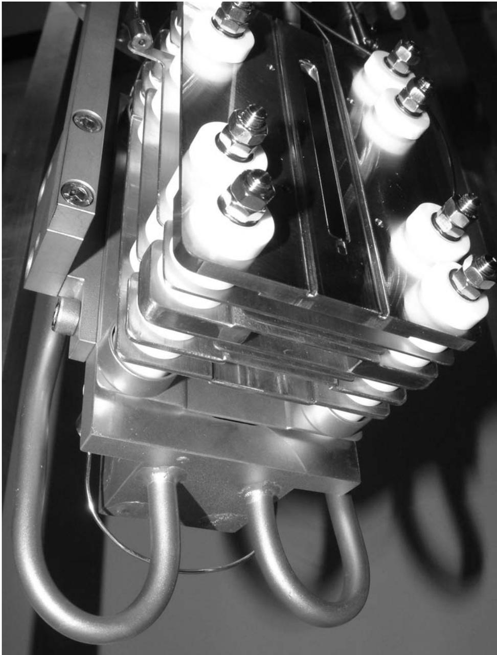
Abbildung A.7: Ansicht der neu konstruierten Elektronenkanone von unten. Der neue Kollektor mit der geänderten Kühlwasserführung ist deutlich zu erkennen. Die Kathode war zum Zeitpunkt der Aufnahme nicht montiert.
