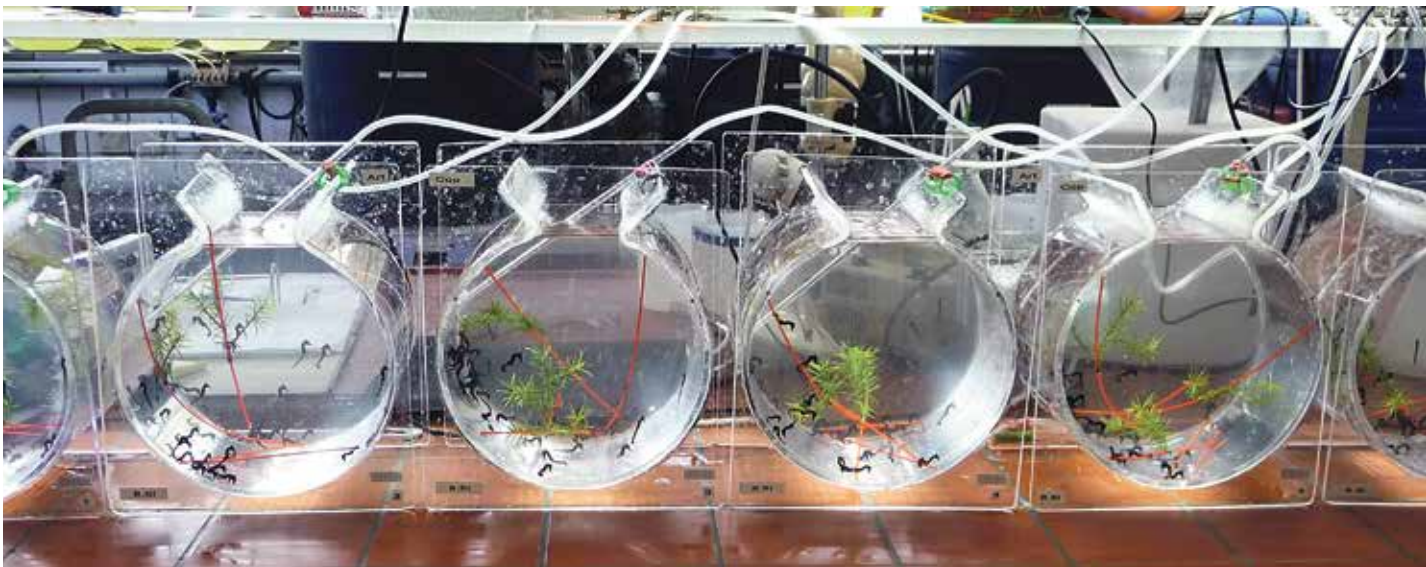
Kreiseldesign einer Seepferdchen-Aufzuchtanlage am Interdisziplinären Forschungszentrum für biowissenschaftliche Grundlagen der Umweltsicherung (IFZ).
