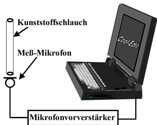
Abb. 4.2.3/3 Komponenten des Equipments zur Verifizierung der Hörerposition.
