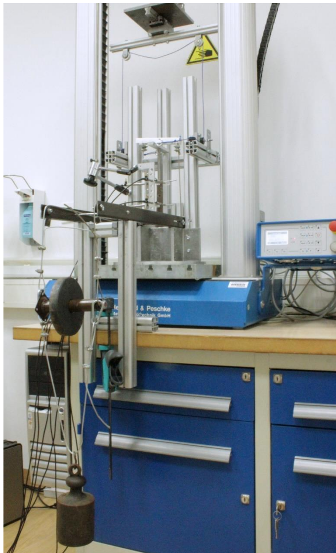
Abbildung 24: Gewichtsbelastung der Prothese mit 7,7 kg
