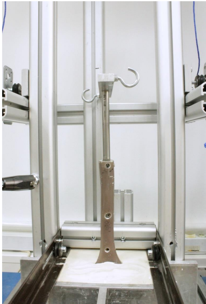
Abbildung 14: Implantierte Prothese mit Aufsatz im Kunstknochen
