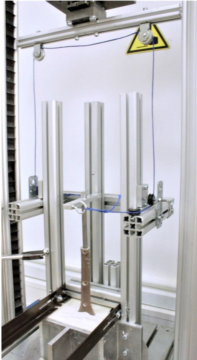
Abbildung 15: U-Form Strebenprofilssystem mit Fadenführung über Umlenkrollen
