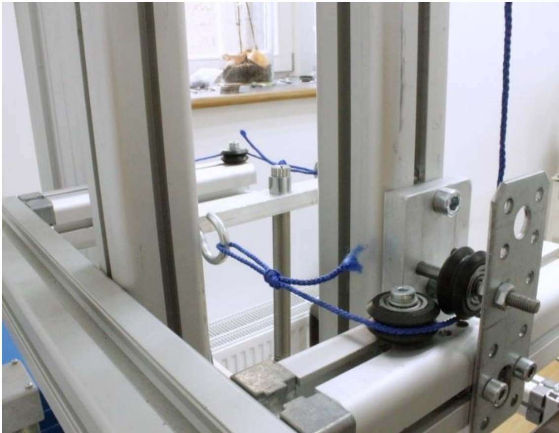
Abbildung 16: Ansicht von schräg hinten zur Darstellung der Umlenkrollen und der Fadenführung
