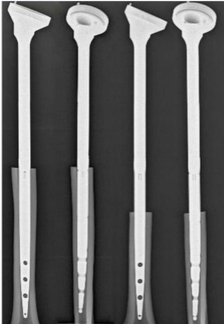
Abbildung 10: Röntgenkontrolle der Prothese in Kunstknochen von dorsal und medial, 200 mm Schaftlänge (links) und 160 mm Schaftlänge (rechts)
