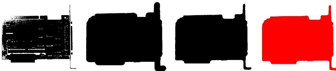
Abbildung 5.4: Veranschaulichung der BLOB-Detektion anhand einer Platine. Von links nach rechts: Selektierte Messwerte mittels Höhenschwellwert, anschließender Dilatation, Erosion und BLOB-Detektion.
