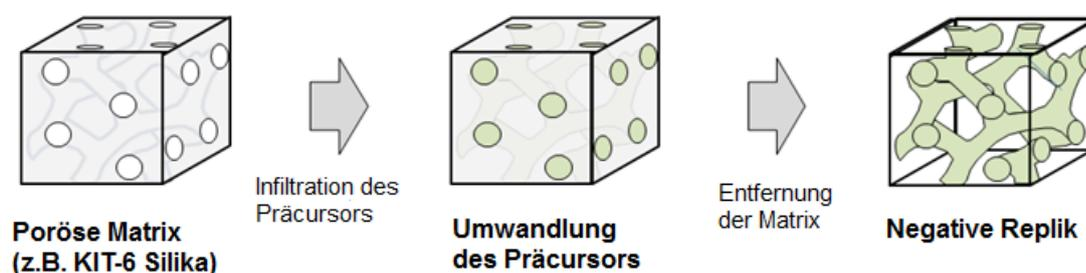
Abbildung 11: Schematische Darstellung des nanocasting Verfahrens [adaptiert von SMS13]
