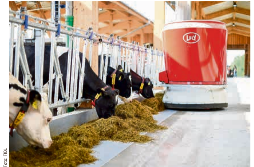
Fütterungsroboter im neuen Milchviehstall auf dem Gladbacherhof, einem Lehr- und Versuchsbetrieb der JLU für Ökologischen Landbau.
