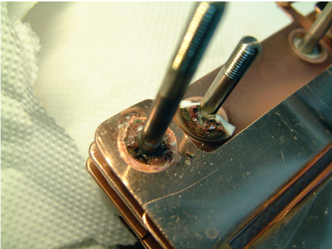
Abbildung 5.6: Eine Fotografie eines Teils der Elektronenkanone. Sie zeigt durch zu hohe Leistung auf den Elektroden verursachte Schäden.
