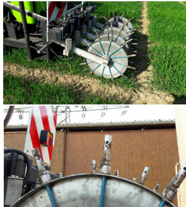
Abbildung 7: Injektionsvorrichtung des CULTAN-Verfahrens im Weizenbestand (oben); Injektionsdüse, die in den Boden einsticht und die DüngeLösung appliziert (unten) (J. Hees)
