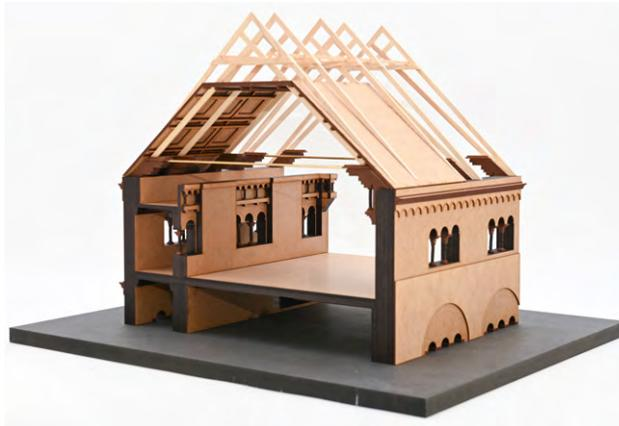
Das Modell zeigt das Tragwerk des FestsaaIs mit trapezförmiger Decke, wie es von Ritgen entworfen und ausgeführt wurde. Bereits im 19. Jahrhundert wurden von seinen Festsaalentwürfen Holzmodelle angefertigt, um eine Entscheidungsfindung zu erleichtern.
