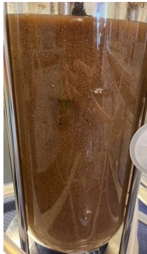
Abbildung 3-21: Bioreaktor mit 5 L SBT-Medium nach der Fermentation mit P. ostreatus
