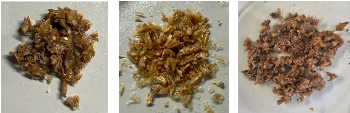
Abbildung 2-1: In dieser Arbeit verwendete Biertreber (von links): Weizenbier (WT), Pilsenerbier (PT) und Schwarzbierbier (SBT)
