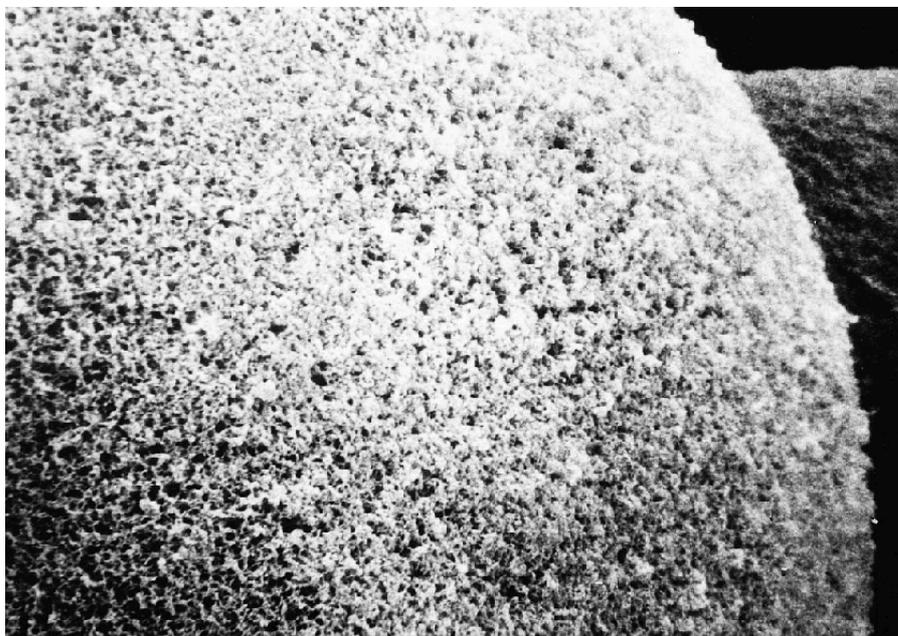
**Abbildung 2.1** Ein Galaktosepartikel von Echovist® (rasterelektronenmikroskopische Aufnahme) mit poröser Oberfläche, an welcher nach Präparation Luftbläschen anhaften und bei Auflösung der Galaktose freigesetzt werden
