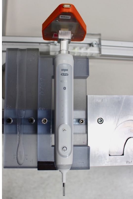
Abbildung 11b: Registrierungsposition elektrische Zahnbürste, der Bürstenkopf konnte nachträglich aufgesteckt werden und war für den Teachingprozess nicht obligatorisch
