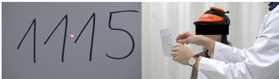
Abbildung 19: Laserpointersignal (roter Punkt im linken Bild) als Synchronisationszeitpunkt für die Auswertung von Videoanalyse und Analyse des Motion Tracking System. Der Code „Sync“ wurde gesetzt, sobald das Licht des Laserpointer das erste Mal zu sehen war. Bildschirmfoto von originalem Video.
