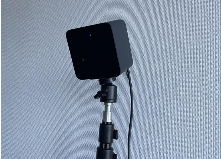
Abbildung 3-11 lighthouse Positionserfassung (eigene Darstellung)
