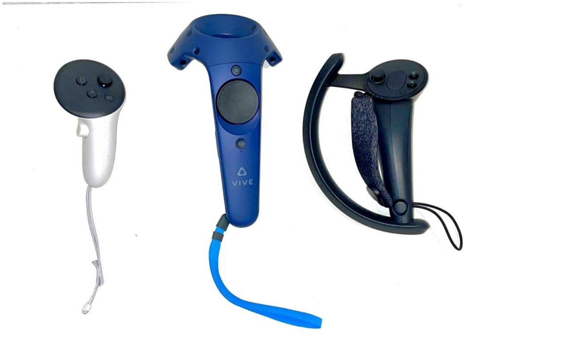
Abbildung 3-2 VR-Controller verschiedener VR-Systeme: links = Meta Quest 3, mitte = HTC Vive, rechts = Valve Index (eigene Darstellung)
