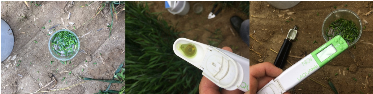
Abbildung 42: Illustration des Nitracheck-Schnelltests zur Feststellung der Nitratkonzentration im Saftstrom der Weizenpflanze (eigene Darstellung und Aufnahmen)
