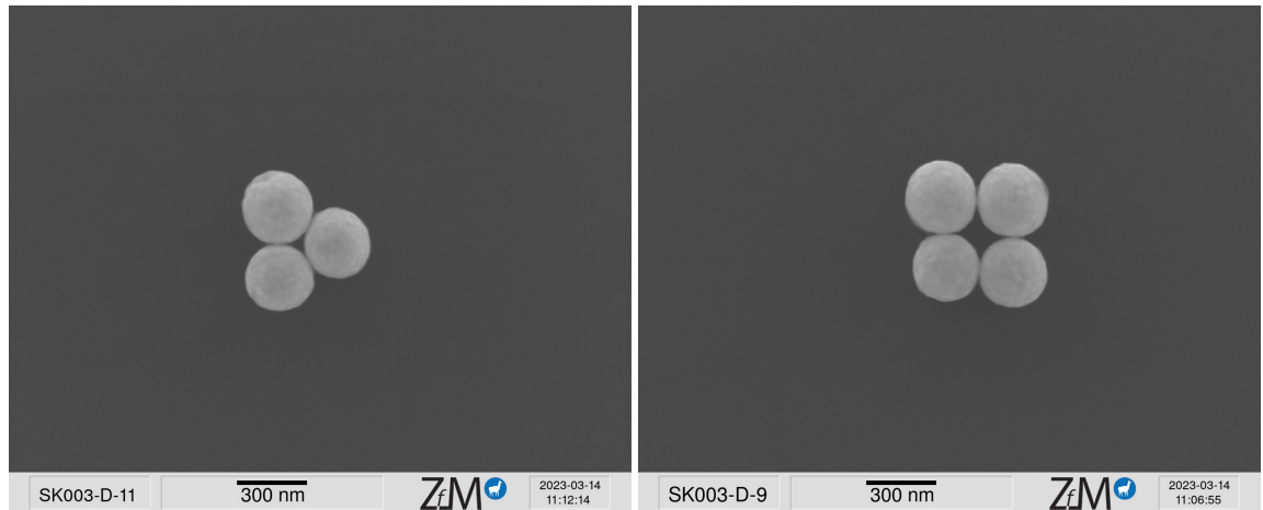
Abbildung 3.19: Links: dreieckige Anordnung mit drei Partikeln. Rechts: quadratische Anordnung aus vier Partikeln.
