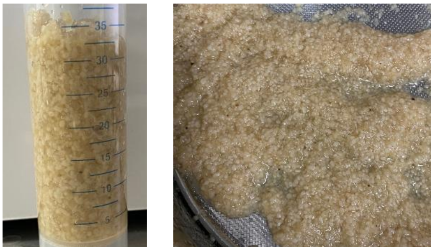
Abbildung 34: Fotos des Mycels von L. squarrosulus nach 6-tägiger Kultivierung im 30-Liter Bioreaktor Im 30-Liter-Bioreaktor wurden zwanzig Liter Rübenschnitzel-Melasse-Medium mit einfacher Substratkonzentration mit zwei Litern einer 6-tägigen, homogenisierten Vorkultur von L. squarrosulus inokuliert. Die Kultivierung erfolgte bei 24 °C und pH 6 für 6 Tage. Die Ernte des Mycels erfolgte mittels 1 mm Sieb und Passiertuch.
