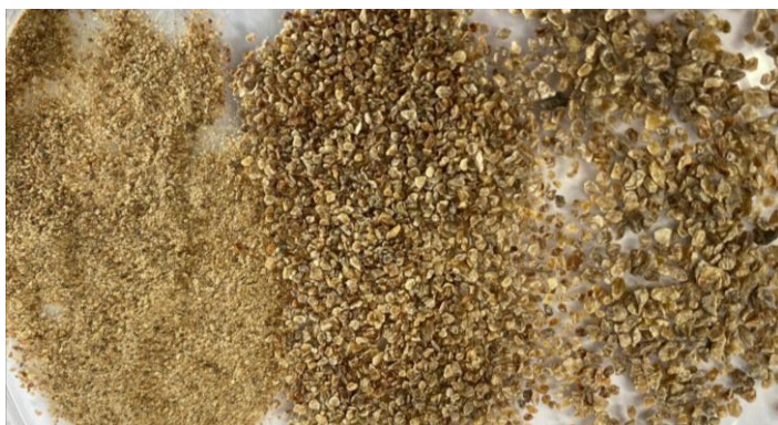
Abbildung 5: Verwendete Mahlgrade der Rübenschnitzel für die Optimierung der Kultivierung Die Rübenschnitzel wurden mittels Schneidmühle zerkleinert und die verschiedenen Mahlgrade durch Sieben getrennt. Die Mahlgrade betragen 0,5 mm, 1 mm und 2 mm.
