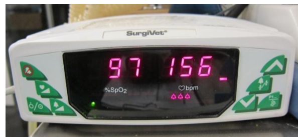
Abbildung 20: Pulsoxymeter. Es wird die periphere Sauerstoffsättigung des Blutes (%SpO 2 ) und die Pulsfrequenz (bpm) angezeigt.
