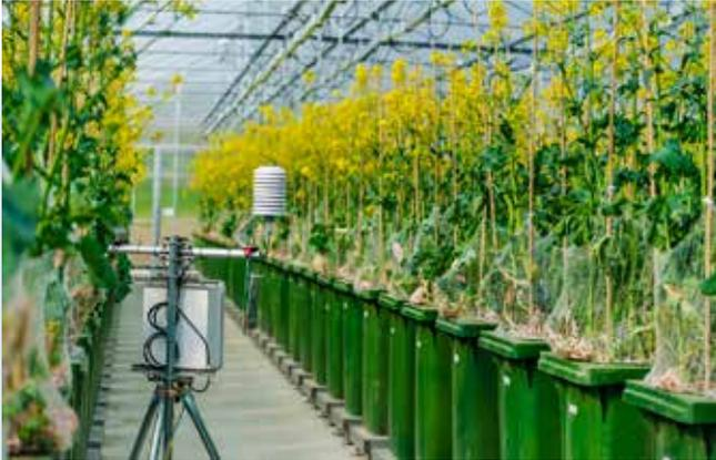
Abbildung 3. Die Anlage »DroughtSpotter XXL« ist weltweit einzigartig. Sie erfasst ganzjährig, in fünfminütigen Abständen und automatisch Reaktionen von Pflanzen auf Dürrestress.
