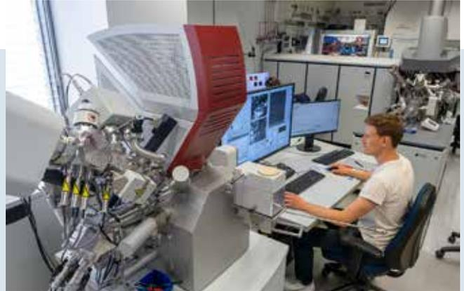
Abbildung 4. Batterieforschung mit Großgeräten: Untersuchung eines Querschnitts durch eine Batterieprobe in einem Rasterelektronenmikroskop mit fokussiertem Ionenstrahl.
