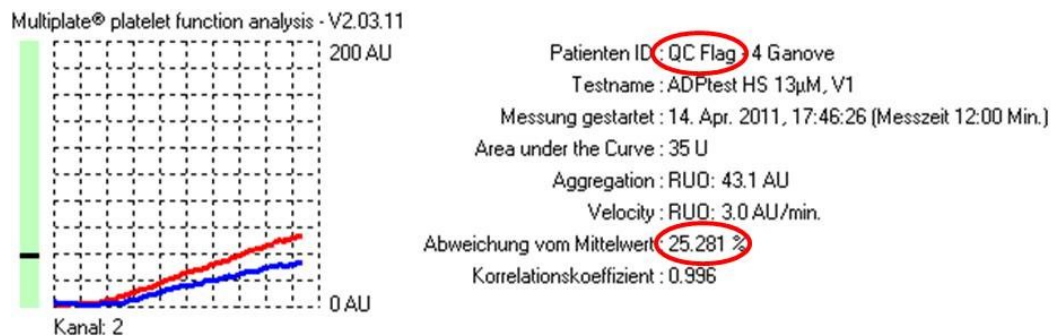
Abbildung 8: Multiplate® Analyzer - Messprinzip: Markierung einer Messung mit QC Flag aufgrund prozentualer Abweichung beider Messungen vom Mittelwerte um mehr als 20 %
