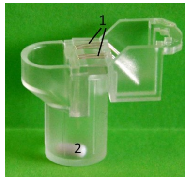
Abbildung 5: Multiplate® Analyzer: Einmalküvette mit paarigen Messeinheiten (1) und Rührstab (2)
