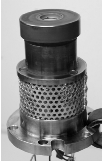
Abb. 6.7: Foto des Probenhalters für die impedanzspektroskopischen Messungen.
