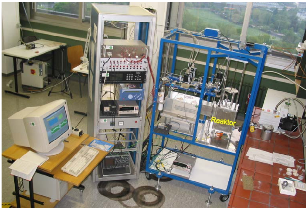
Abb. 6.1: Foto der aufgebauten RF-Plasmaapparatur. Links im Bild befindet sich der Messrechner, daneben der Einbauschränk mit den Steuergeräten und rechts davon das Gestell mit dem Plasmareaktor. Der Reaktor befindet sich in der rechten Hälfte des Gestells. Im linken Teil sind die Gasversorgung und das Anpassungsnetzwerk untergebracht.
