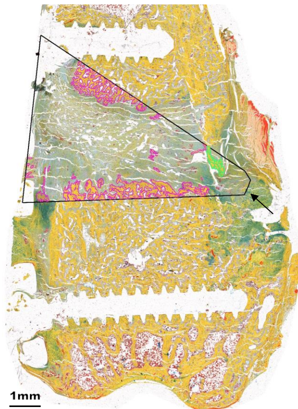
Abbildung 6: Histomorphometrische Untersuchung. Festlegung der (→) ROI. Übersichtsaufnahme der Movat-Pentachromfärbung. Innerhalb der ROI violett markiert: Mineralisierte Areale. Hellgrün markiert: Lagerknochen (VOID).
