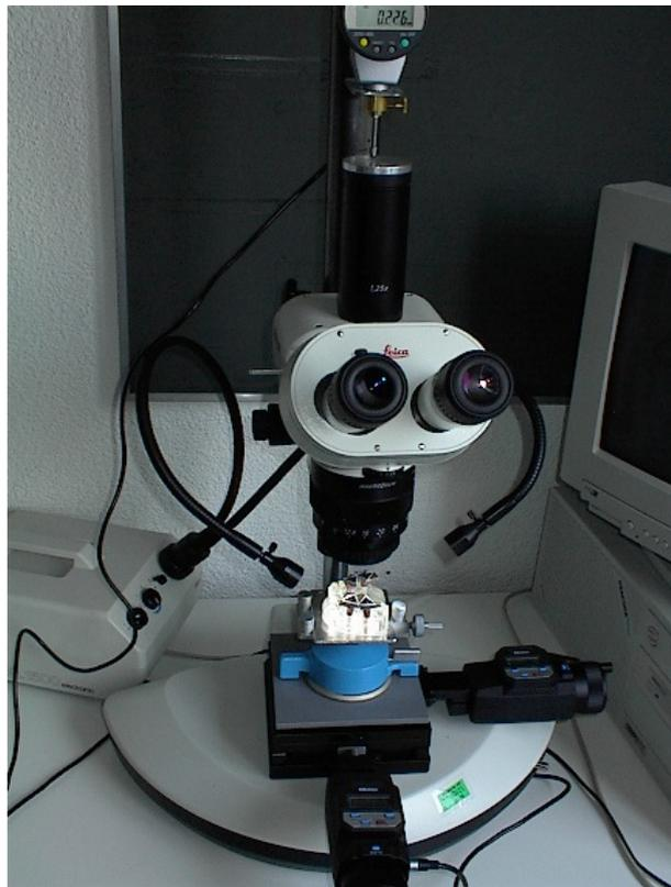
Abb. 4.5 Messmikroskop mit einem Modell zum Vermessen auf dem Messtisch
