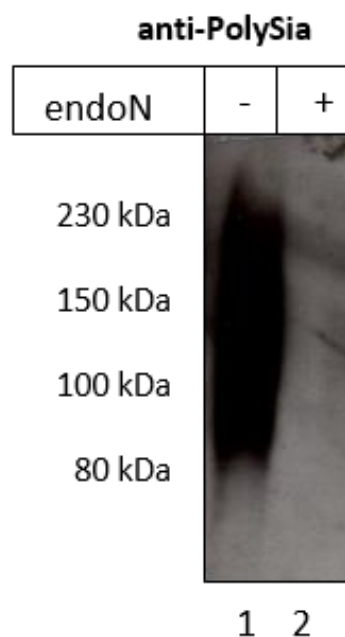
Abbildung 8: Western Blot-Analyse polysialylierter Proteine in FBS. Spur 1 zeigt die unbehandelten FBS-Proben, Spur 2 zeigt die Serumproben nach EndoN-enzymatischem Verdau. Es handelt sich hier um eine Immunfärbung mit einem monoklonalen anti-PolySia-Antikörper (mAk) (Unterpunkt 3.3.1). Die molekularen Größen sind in Kilodalton (kDa) angegeben. Pro Spur wurden 5 µl FBS aufgetragen.
