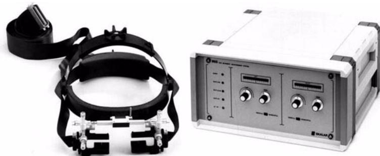
**Abbildung A3.1.** Kopfbasiertes Infrarot-Blickrichtungsmessgerät bestehend aus einem leichten Sensorhelm (links) und einer Verstärkereinheit (rechts).
