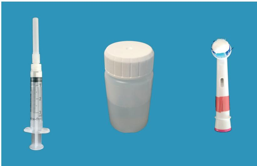
**Abbildung 3.5:** links: 0,5 Gramm Zahnpaste in Einmalspritze; mittig: 10 ml Mundspüllösung in Szintillationsfläschchen; rechts: 0,5 Gramm Zahnpaste auf Bürstenkopf
