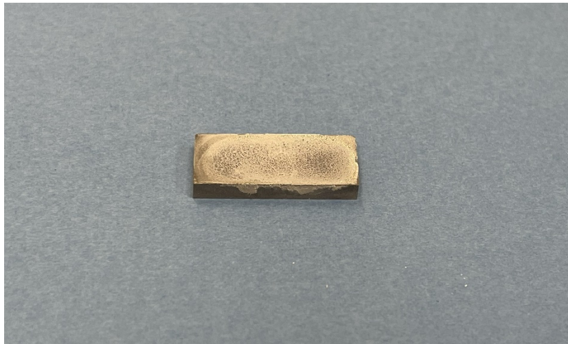
Abb. 18 Polierter Prüfkörper aus CoCr mit Titanat
