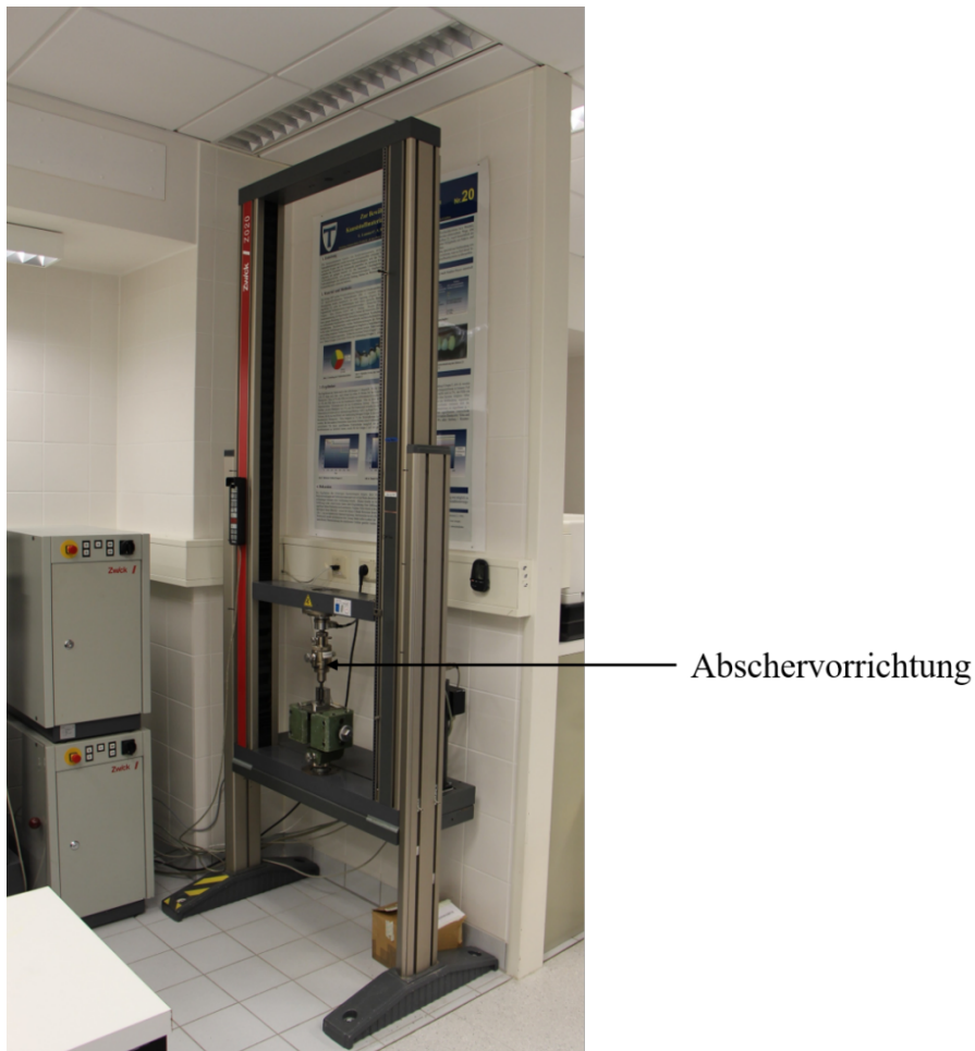
Abb. 26 Universalprüfmaschine mit Abschervorrichtung
