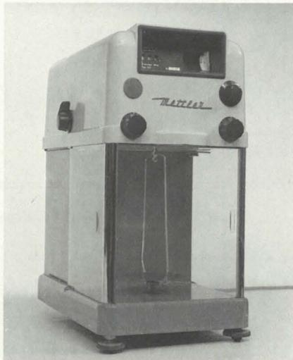
Abb. 28: Substitutions-Zweischneidenwaage H6, Mettler-Waagen-Spoerhase AG, Giessen, 1960.
