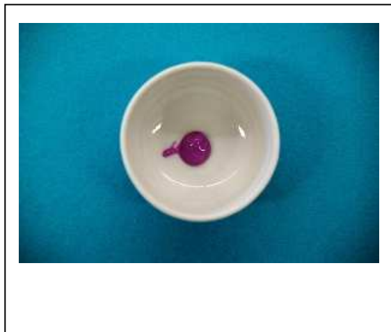
Abbildung 4.9: Befüllter Tiegel vor der Veraschung der Abformmasse
