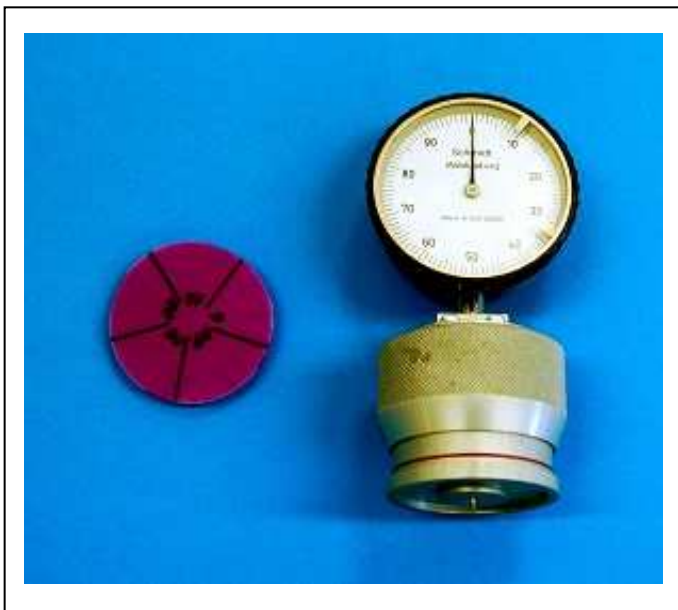
Abbildung 4.8: Beschrifteter Prüfkörper vorbereitet für die Messung mit dem Prüfgerät
