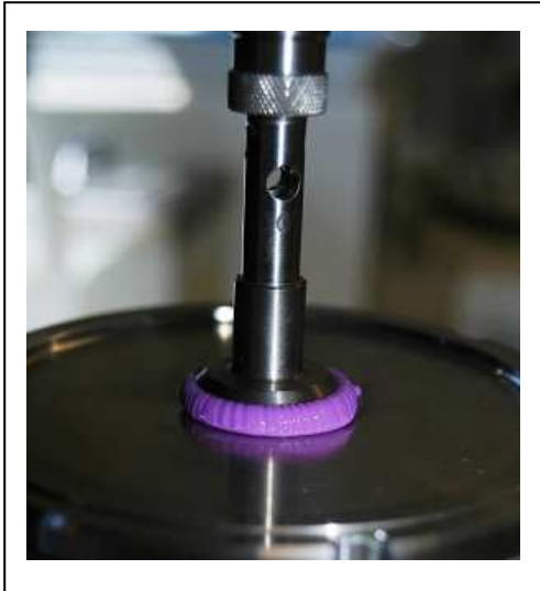
Abbildung 4.7: Prüfmaterial während der Messung mit dem Rheometer
