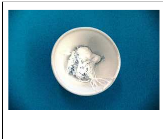
Abbildung 4.10: Tiegel nach der Veraschung mit Glührückstand
