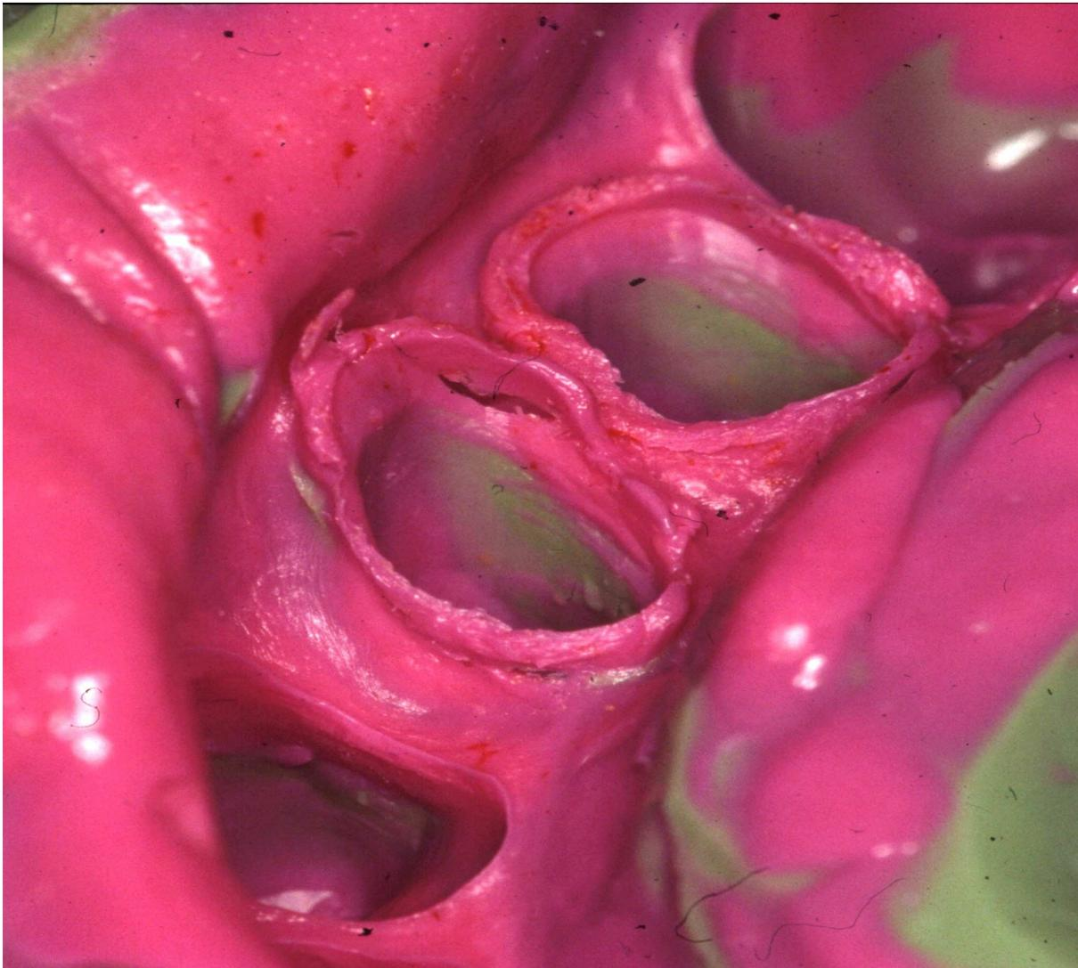
Abbildung 2.1: Präzisionsabformung mit ausgerissener Silikonfahne
