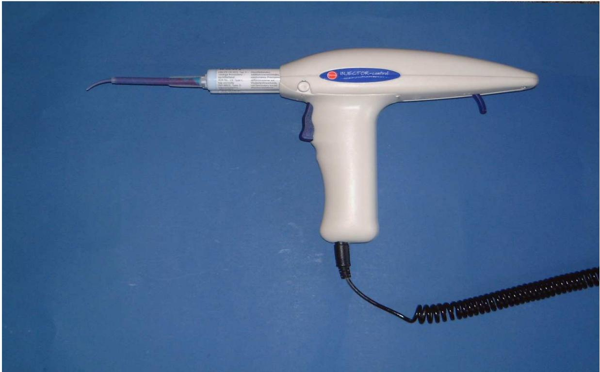
Abbildung 4.4: Elektrisch betriebener Statikmischer
